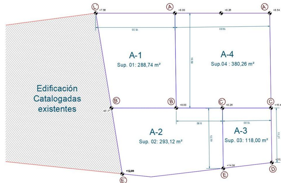
Ilustración 5: Plano de superficies, redibujado según plano de Ordenación Detallada
