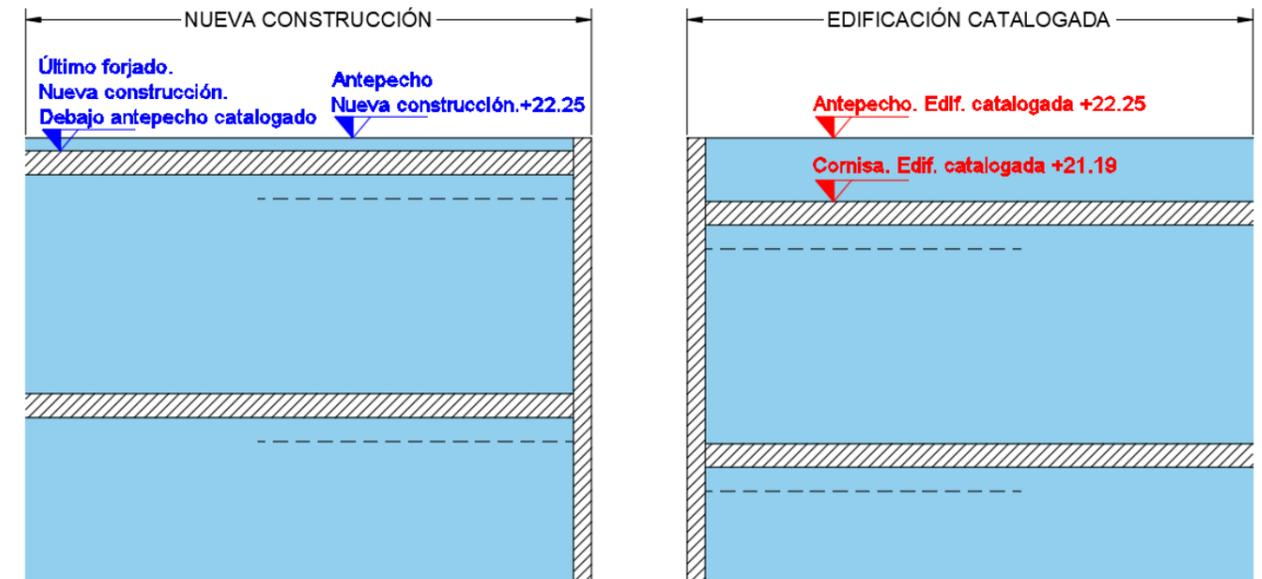
Ilustración 11: Sección Nueva construcción-Edificación catalogada
